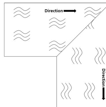
Если длина одной из соединяемых сторон меньше 760 мм (ширина стандартного листа), лучшим решением может быть параллельное соединение. Боковая часть серии Aurora "M6XX" немного темнее, чем средняя часть. Поэтому, если вы хотите уменьшить разницу в цвете, отрежьте 50-100 мм боковой части от края стандартного листа, а затем соедините. См. раздел "Соединение "бок в бок"" в этом разделе.
