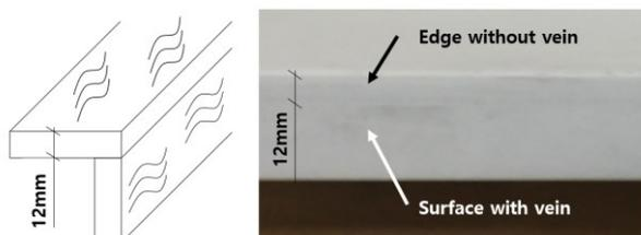
Рис. 1-2. Различное направление и разрез прожилки поверхности
